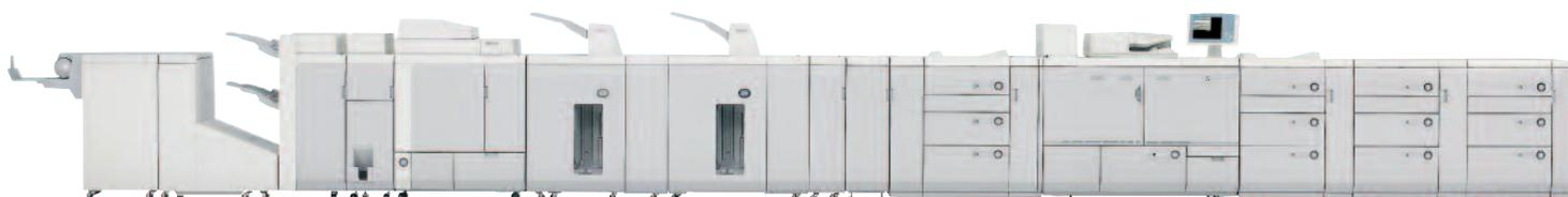
Die neuen imagePress Systeme sind modular aufgebaut und lassen sich bedarfsorientiert zusammenstellen. In der hier abgebildeten Voll-Konfiguration verfügt das System (von rechts) über Papiermagazine, den Drucker, einen
