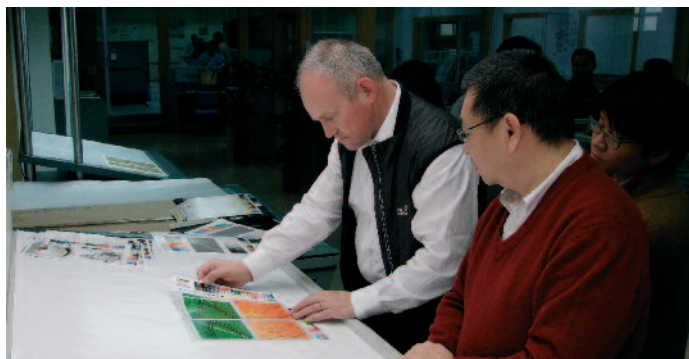
Mit PSO sind bei jedem Arbeitsschritt alle Parameter klar festgehalten. Für den visuellen Vergleich zwischen zwei Druckprodukten ist auch das korrekte Umgebungslicht in einer ISO-Norm definiert.
