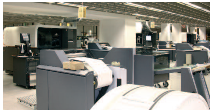
Inkjet-Trio von Kodak: Die drei Inkjet-Drucksysteme aus der Kodak Versamark VL-Serie produzieren bei der Credit Suisse von Rolle auf Rolle.
