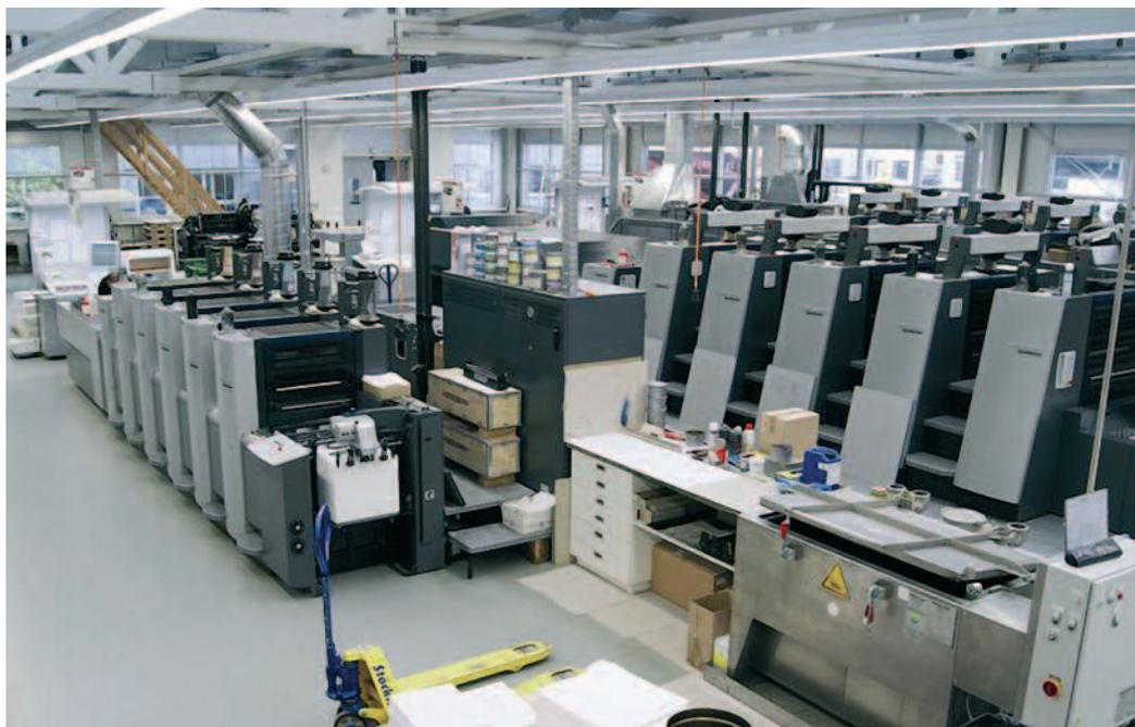
Der Maschinenpark im Druckzentrum mit der Zehnfarben-Maschine, einer Fünffarben XL 75 mit Lack, einer Fünffarben mit Lack und Anicolor im Format 32 x 52 cm sowie kleinformatigen Ein- und Zweifarbenmaschinen lässt dabei eine Vielzahl flexibler Anwendungen zu. So produziert Vögeli beispielsweise hochwertige Akzidenzien mit verschiedenen Lackapplikationen mit Dispersions- und anderen Drucklacken. Ein weiteres Standbein ist die leistungsstarke Mailling- und Lettershopproduktion.
