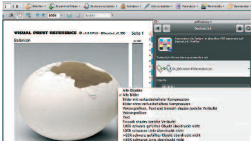
DeviceLink basierende Farbraumtransformation von kompletten Dokumenten mit Callas pdfToolbox für Adobe Acrobat.
