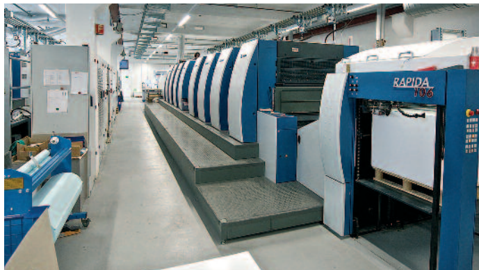
Zwei KBA Rapida 106 in Sechsfarben- und Achtfarbenausführung plus Lack bilden das Herzstück der Druckerei. Die offene Systemarchitektur des Leitstands
