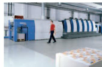
Die Fischer AG für Data und Print hat sich nach 2008 für eine weitere KBA Rapida 106 entschieden. Es handelt sich dabei um eine Fünffarben-Geradeaus-Konfiguration mit Lackturm und verlängerter Auslage. Installiert wird die Maschine im neuen Businesspark Grünau in Wabern. Dort werden die Ast & Jakob, Vetsch AG und die Fischer AG ein gemeinsames Medienvorstufen- und Druckzentrum einrichten.
