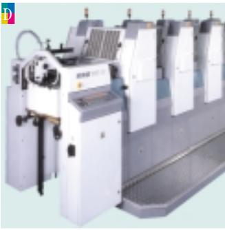
557 CDI ist das zweite Modell der Digital-Imaging-Maschinen von Adast. Bebildert werden die Platten mit 32 Laserdioden je Druckwerk. Abhängig von der Auflösungsfeinheit der Rasterweite von bis zu 80 Lin/cm benötigt die 557 CDI für das Format A3+ zwischen 2:45 und 5:30 Minuten.
