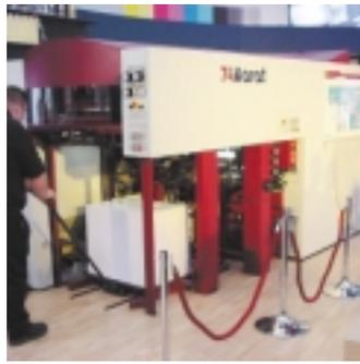
Die 74 Karat verbindet die Vorteile des wasserlosen Offsetdrucks mit einem durchgehend digitalen Workflow. Dabei ist die Karat von ihrer Konzeptionsphilosophie besonders interessant. Mit der digitalen Offsetmaschine wurden Automatismen eingeführt, die eine völlige Abkehr von der bisherigen Druckmentalität bedeuten.
