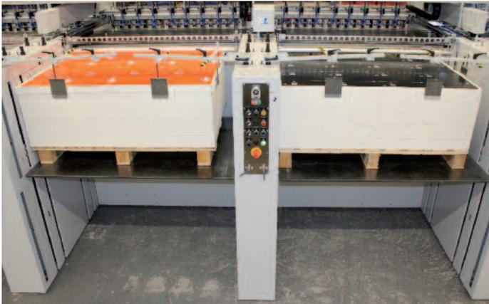
*Bogen mit einer Größe von 1,36 m<sup>2</sup> und 80 g/m<sup>2</sup> Flächengewicht sind eine echte Herausforderung für Material und Maschine.*
