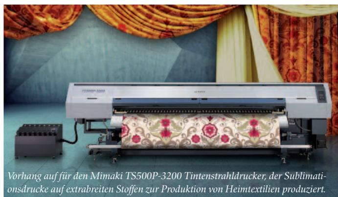
Vorhang auf für den Mimaki TS500P-3200 Tintenstrahldrucker, der Sublimationsdrucke auf extrabreiten Stoffen zur Produktion von Heimtextilien produziert.
