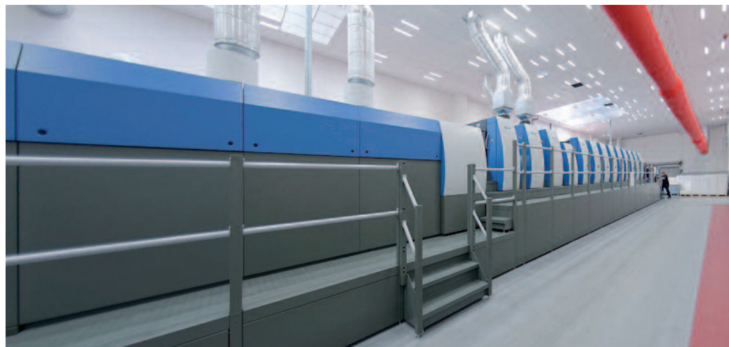
Beindruckend und einzigartig in der Slowakei: die ca. 28 m lange 13-Werke-Maschine Rapida 106 bei Grafobal.
