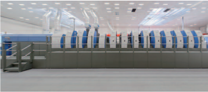
Mit bis zu 18.000 Bogen/h, neun Druckwerken und jeweils zwei Lack- und Trockentürmen vereint die hoch automatisierte Rapida 106 in Skalica höchste Produktivität mit optimalen Druck- und Veredelungsoptionen.
