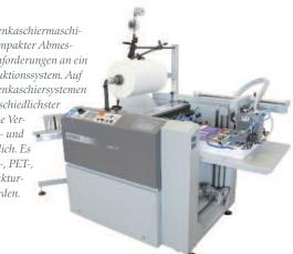
terial gedruckt. Anschließend werden die Druckbogen mit der Sleeking-Folie in einem Laminiergerät mit Druck und Hitze übertragen und so der gewünschte Metalleffekt aufgebracht. An den Stellen, auf die der Toner gedruckt wurde, verbindet sich die metallisierte Schicht mit dem Trägermaterial und erreicht ein einwandfreies Druckveredelungsergebnis mit hoher Feinheit.
