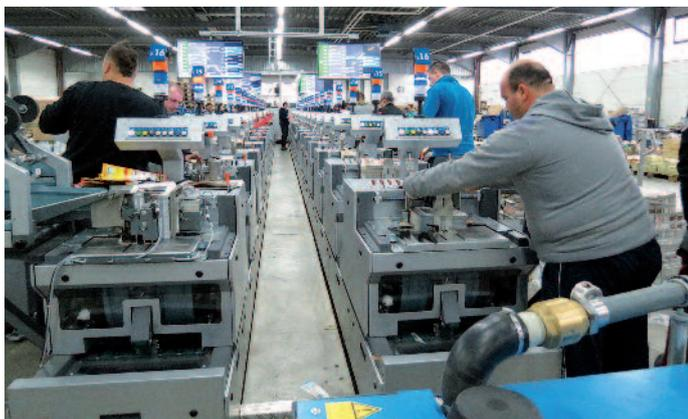
Die Anlage bei der afd Direktwerbung umfasst zwei Mal 17 Anleger und liefert perfekt gebündelte Sets, fixiert mit einer Kreuzumreifung.
