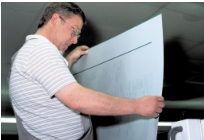
Eine Extrema.2G wird an einem Roland 700-Druckwerk in den Ladeschacht für den automatisierten Plattenwechsel eingeführt. Im Druckbereich geben zwei Roland 700-Maschinen den Ton an.
