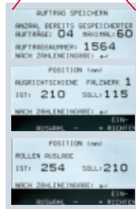
Die computergesteuerte Falzmaschine multimaster CAS 52 SetMATIC (oben) verfügt über ein Bedienpult als Steuerzentrale. Von hier aus lassen sich per Knopfdruck alle wichtigen Einstellungen vornehmen. Verschiedene Displayanzeigen führen den Bediener.
