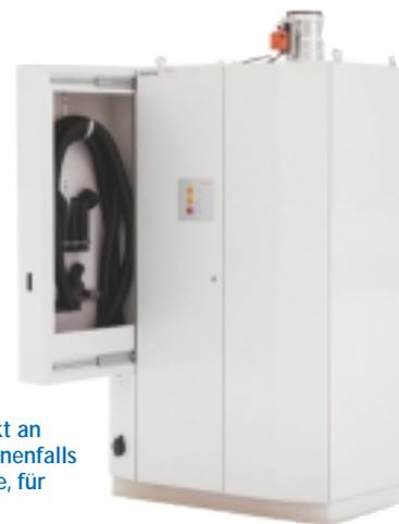
**Baldwin GraphiVac sorgt direkt an der Puderbestäubung, gegebenenfalls im Trockner und in der Auslage, für saubere Luft.**
