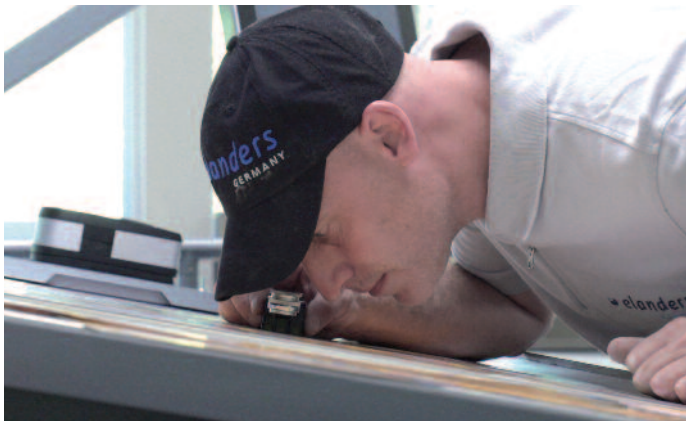
Doch bei aller Automatisierung geht es nicht ganz ohne den Menschen. Die Bogenkontrolle ist wesentlicher Teil des Qualitätsprozesses.
