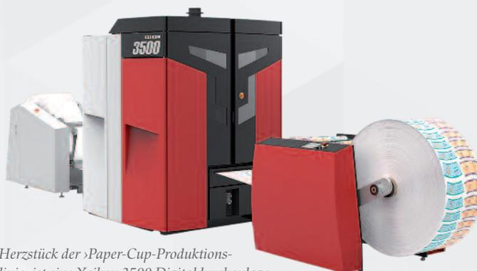
Herzstück der »Paper-Cup-Produktionslinie« ist eine Xeikon 3500 Digitaldruckanlage. Produziert wird voll auf Rolle-zu-Rolle in fünf Farben mit 1.200 dpi Auflösung und einer Druckgeschwindigkeit von bis zu 19,2 m/Min. auf Karton mit und ohne PE-Beschichtung.
