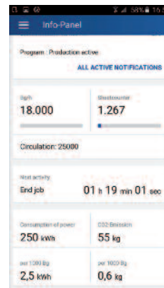
Die Rapida LiveApp unterstützt Bediener bei der Überwachung von Bogenoffsetmaschinen der Rapida-Baureihen. Nach dem Log-in per NFC öffnet sich ein Info-Panel, das Start, Verlauf und den aktuellen Status der Druckproduktion anzeigt.
