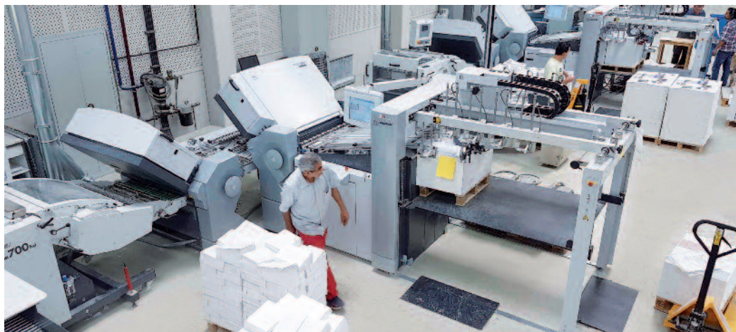
Gerade industriell aufgestellte mehrstufige Druckereien oder Buchbinder erhöhen mit modernen Falzmaschinen (hier ein Heidelberg Stahlfolder TX 96 mit PFX-Anleger) nicht nur ihre Kapazität, sondern auch die Produktivität.
