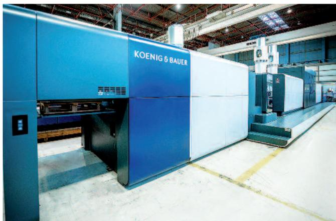
Für den Faltschachteldruck soll das modulare Konzept der VariJet die Kombination von Inkjet-Druck mit den aus dem Offset bekannten Druck- und Inline-Veredelungsmöglichkeiten ermöglichen.
