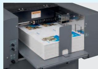
Der DC-646 Pro hat ein einzigartiges Einzugsystem, das mit Saug- und Blasluft ausgestattet ist, um eine präzise und fehlerfreie Zufuhr der Bogen zu gewährleisten.
