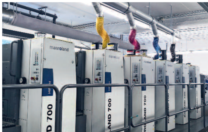
Die Absaugung erfolgt direkt am Walzenstuhl. Die Nebelpartikel werden über eine Rohgassammelleitung mit hoher Geschwindigkeit weggetragen.
