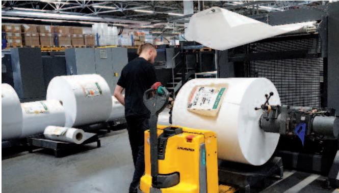
Rollenwechsel an einer Bogenoffsetmaschine Speedmaster XL 106: Beide Mittelformatmaschinen und eine Speedmaster XL 162 sind mit dem Rollenquerschneider CutStar ausgestattet.
