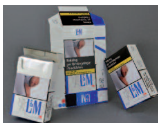
Die Abbildungen und Markenfarben sind digital im erweiterten Farbraum inklusive Weiß gedruckt. Danach wurde ein UV-Silber im Flexodruck gedruckt, gefolgt vom ersten UV-Mattlack, der etwas rauer eingestellt ist und danach der zweite UV-Mattlack. Zum Schluss werden alle L&M Embleme geprägt.
