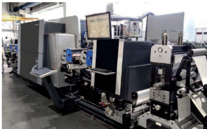
In die Gallus Labelfire ist eine äußerst kompakt gebaute Embellishment-Einheit der Steinemann AG integriert.
