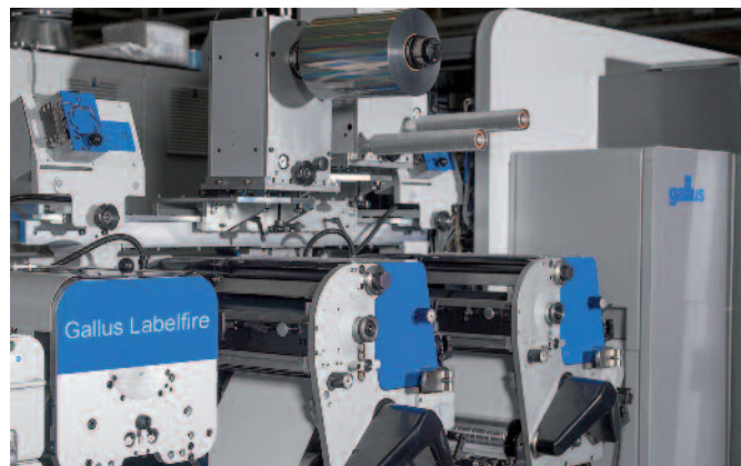
Die Kaltfolieneinheit bei der Maschine für Philip Morris sitzt über den Flexodruckwerken der Labelfire-Konfiguration.
