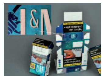
Die Metallic Effekte werden durch online Kaltfolie plus Leimauftrag im Flexowerk erzielt. Die Design-Farben sind im erweiterten Farbraum inklusive Weiß digital gedruckt. Es wurde ein rau eingestellter Mattlack eingesetzt und im letzten Schritt die Markenelemente zusätzlich geprägt.
