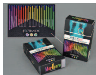
Druck im erweiterten Farbraum inklusive Weiß. Der Matteffekt im Schwarz wird durch Auftrag eines matten UV-Softtouch-Lackes erzielt. Im Gegensatz hebt der glänzende Softtouch-Lack die farbigen Elemente hervor, sichtbar im Marlboro-Schriftzug, der zusätzlich geprägt ist. Im Bild sichtbar sind die Reflexe der Prägekante unterhalb der Buchstaben rlbo.
