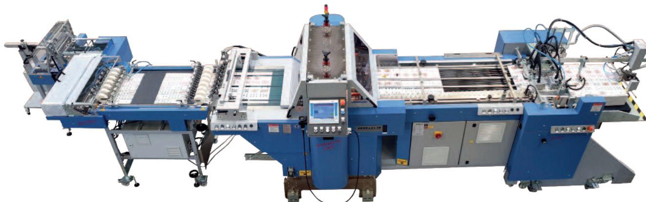
Das System von Bograma für die Spielkartenproduktion ermöglicht Stanzen, Ausbrechen und Schuppen der Druckbogen, automatisierte Stapelbildung zum kompletten Deck und die Weiterführung zum Sammelschachtel via Transportband.
