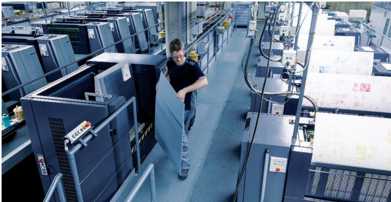
Bei der Druckerei Aumüller in Regensburg arbeitet eine Variante der neuen Heidelberg Druckplattenlogistik »Plate to Gallery«. Hierbei wird der Plattenwagen mit einem Lift auf das Niveau der verbreiterten Gallerie gefahren. Damit will Heidelberg eine Automatisierungslücke schließen, den Drucker und seinen Helfer physisch entlasten, durch den Wegfall von langen Laufstrecken Zeit einsparen und gleichzeitig für höhere Prozesssicherheit sorgen.
