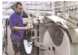
zu steigern. Der Abwickler von Roll Systems wurde zusammen mit einem Schwarzweiß-Endlosdrucker PageStream 350 von Océ installiert; beide Anlagen laufen kontinuierlich im Online-Betrieb. Mit der neuen Fertigungslinie wird Material von 60-170 g/m<sup>2</sup> in Auflagen von einigen Tausend bis zu über sechs Millionen bedruckt.
