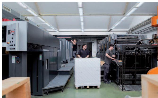
Blick in den Drucksaal mit den beiden Offsetdruckmaschinen der *Benedict Press* im Formatbereich 70 x 100 cm. Daneben produzieren kleinformatigere Offset- und Digitaldruckmaschinen in Münsterschwarzach.
