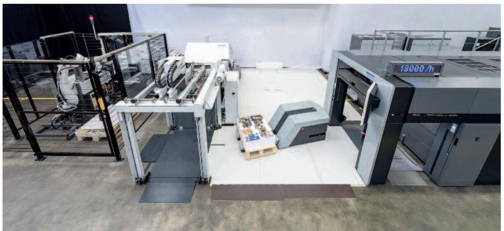
Mit einem bedienerlosen Transportsystem wird der fertig gedruckte Bogenstapel an die Falzmaschine Stahlfolder KH 82-P gefahren. Diese ist ebenfalls über das Push-to-Stop-Konzept integriert und erkennt die nächste Signatur automatisch am mitgedruckten Barcode.
