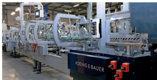
Die Faltschachtelklebemaschine Omega Allpro 110 ist optisch bereits an die Produktpalette von Koenig & Bauer angepasst. Dabei ist sie dank ihrer Vielseitigkeit für die Produktion bei Vogtland Kartonagen wie geschaffen.
