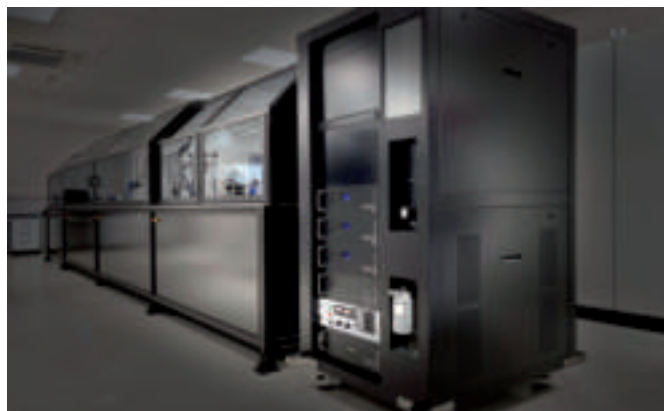
Herzstück des Zentrums für funktionale Drucktechnologien in Freiburg ist eine speziell für funktionalen Druck entwickelte Maschine. Sie ermöglicht die Anwendung zahlreicher Druckverfahren und verarbeitet die unterschiedlichsten Materialien.
