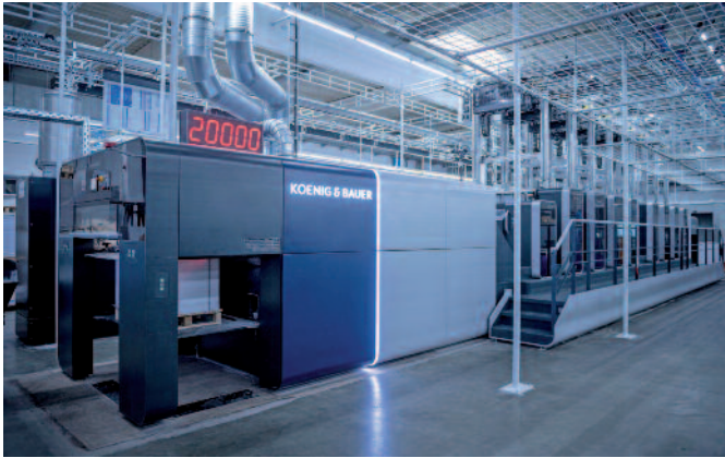
Die Achtfarben-Rapida 106 X mit Wendung für die 4-über-4-Produktion und zusätzlichem Lackturm ist das neue Herzstück im Drucksaal von Krüger Druck+Verlag.
