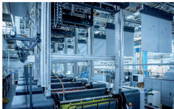
laufen die Platten nach vorgesehener Druckreihenfolge zur Rapida 106 X . Hier der Plattensatz in Bereitschaft für den Wechsel.
