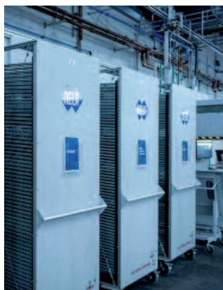
Jede Druckplatte erhält einen Code. Mit ihm erfolgt gleich nach der Belichtung die Bereitstellung in den Plattenspeicher. Aus dem Plattenspeicher mit insgesamt 256 Plätzen
