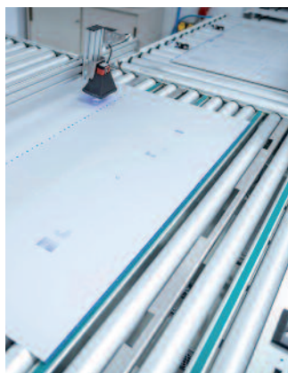
Jede Druckplatte erhält einen Code. Mit ihm erfolgt gleich nach der Belichtung die Bereitstellung in den Plattenspeicher. Aus dem Plattenspeicher mit insgesamt 256 Plätzen
