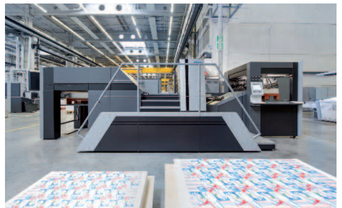
Die rotative Stanze Speedmaster XL 106-D mit nur einem Werk ist Teil des IML-Performance-Pakets und erleichtert Kunden den Einstieg in die IML-Produktion.
