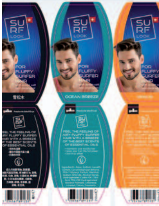
Mit Flying Inprint lassen sich Farben oder Texte ohne Maschinenstopp wechseln.
