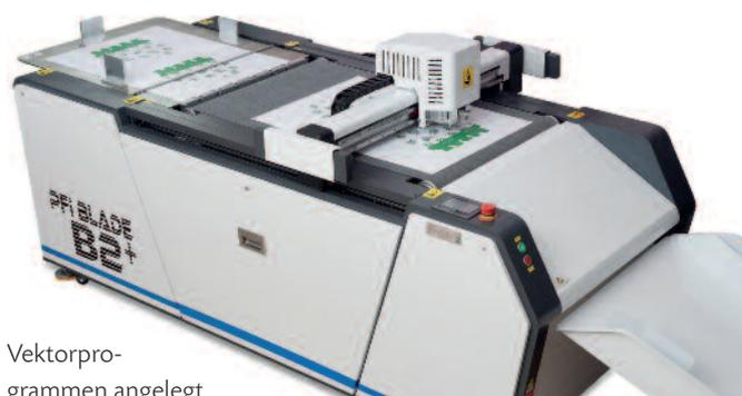
Vektorprogrammen angelegt und in verschiedenen Layern definiert. Mit dem Upload der Job-Dateien können die Layer den entsprechenden Werkzeugen zugeordnet werden. Die Produktion kann über einen QR-Code gesteuert werden. Durch Einlesen der Registermarken via CCD-Kamera können Druckbildschwan-
