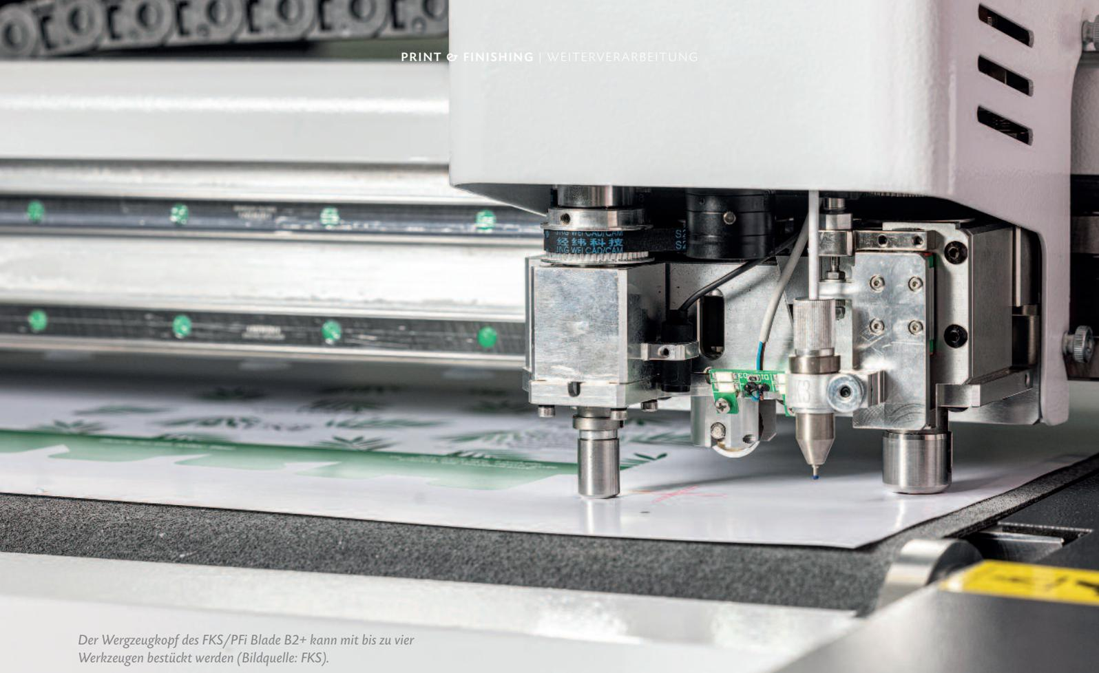
Der Werkzeugkopf des FKS/PFi Blade B2+ kann mit bis zu vier Werkzeugen bestückt werden (Bildquelle: FKS).
