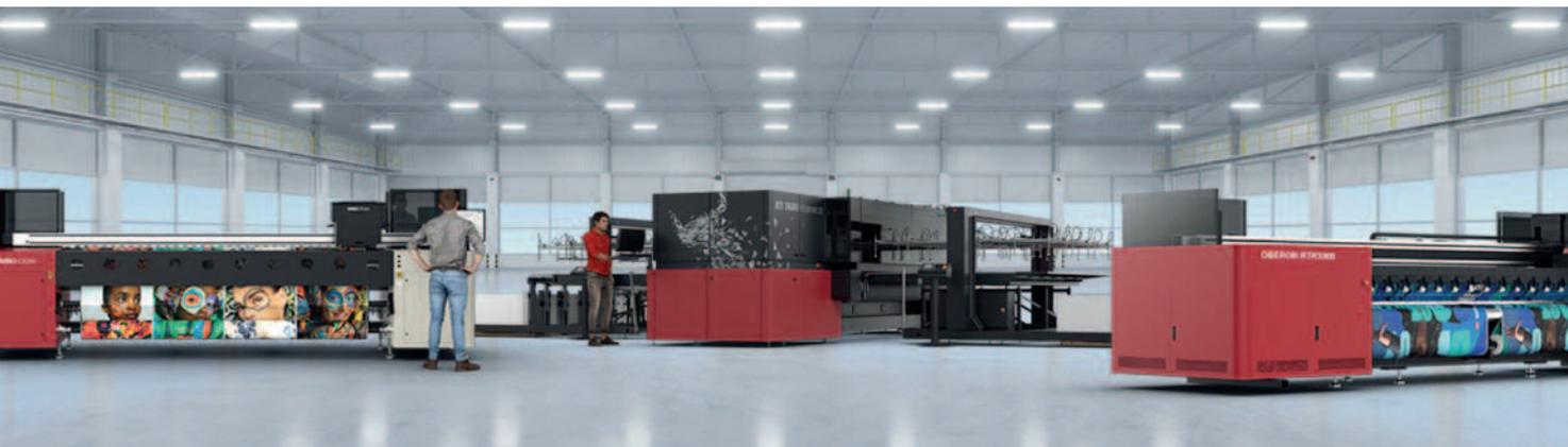
*breites LED-Rollen-drucksystem, das einen hohen Durchsatz mit komfortabler Benutzerfreundlichkeit bietet. Ausgestattet mit UV-LED Härtung und einem wassergekühlten Drucktisch können auch hitzeempfindliche Materialien bedruckt werden.*
