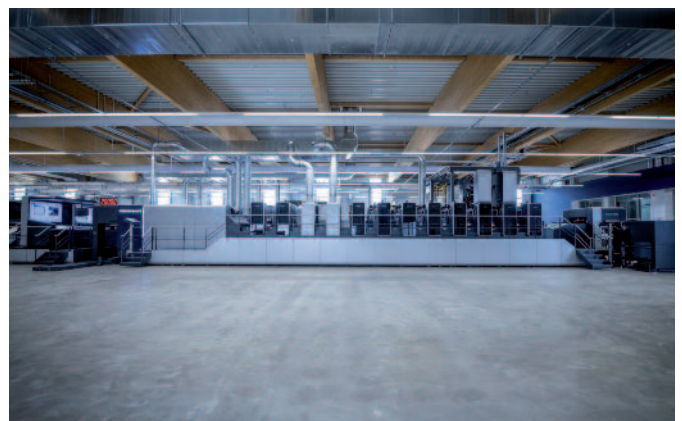
Bogenoffset heute mit einer Rapida 106 X , umfangreicher Ausstattung zur Inline-Veredelung und Druckleistungen bis zu 20.000 Bogen/h.
