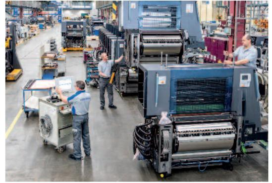
Produktion von Offsetdruckmaschinen am Heidelberg-Standort Wiesloch.
