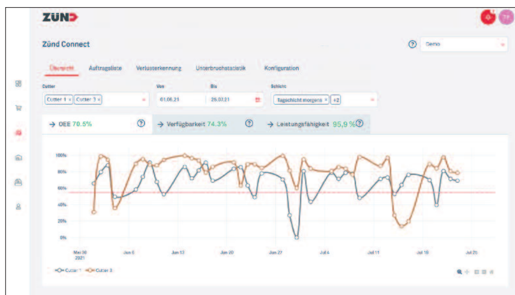
Wichtige Kenndaten auf einen Blick: OEE (Overall Equipment Effectiveness = Gesamtanlageneffektivität), Verfügbarkeit und Leistungsfähigkeit.
