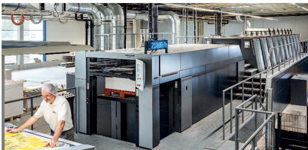
Der internationale Verpackungshersteller *Cardbox Packaging* mit Hauptsitz in Wolfsberg, Österreich, hat die erste Heidelberg *Speedmaster XL 106* mit einer Maximalgeschwindigkeit von 21.000 Bogen pro Stunde in Betrieb genommen.
