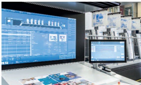
Steuerungssoftware von Heidelberg mit künstlicher Intelligenz ermöglicht die Automatisierung des Druckprozesses bis hin zum autonomen Druck
