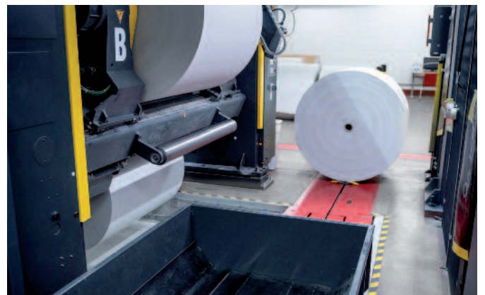
Bewährt und zuverlässig: Patras Rollenhandling für Zeitungsrotationen, etwa bei einer Commander CL.
