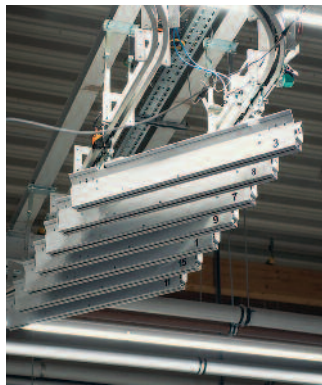
Vereinzelung der Druckplatten vom Plattenwagen (links). Kettenförderer mit Platten-trägern an einer Pufferstation vor der Aufnahmestation.
