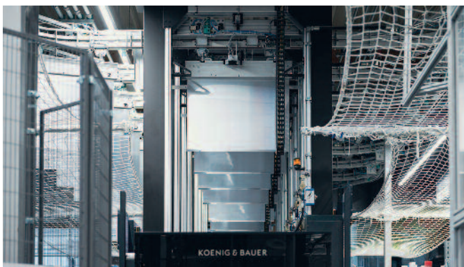
Absenken der Druckplatten direkt in den Platteneinfuhrschacht der Plattenwechsler der einzelnen Druckwerke.
