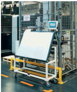
Vereinzelung der Druckplatten vom Plattenwagen (links). Kettenförderer mit Platten-trägern an einer Pufferstation vor der Aufnahmestation.
