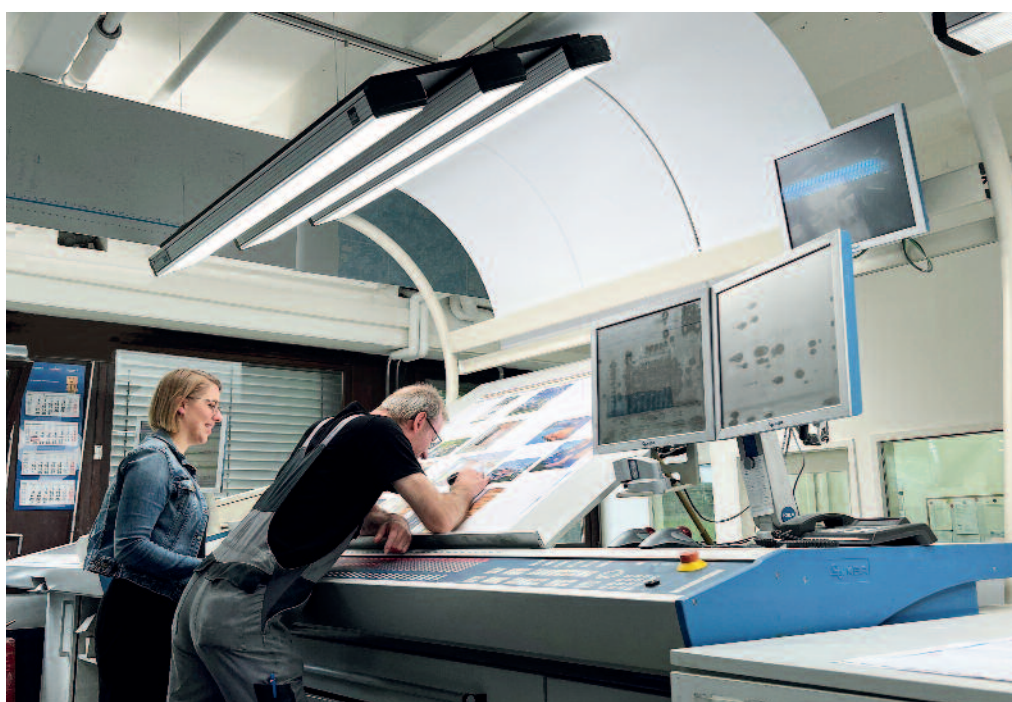
Abmusterung an der Offsetdruckmaschine mit der Just DLS-Retrofit-Lösung. Anwender, die eine Farbprüfstation eines Drittanbieters besitzen, können mit dem Just DLS Retrofit System ihre bestehende Farbprüfstationen umrüsten und profitieren somit von allen Vorteilen des Digital Light Systems, ohne eine komplette Neuanschaffung.
