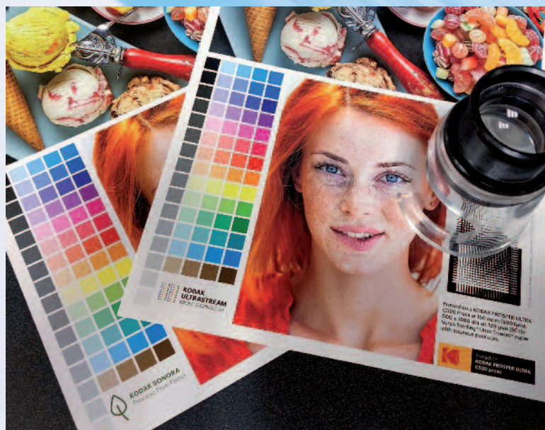
Druckbogen gedruckt auf der Kodak Ultra 520 (rechts) und einen im Offset bedruckten Bogen.
