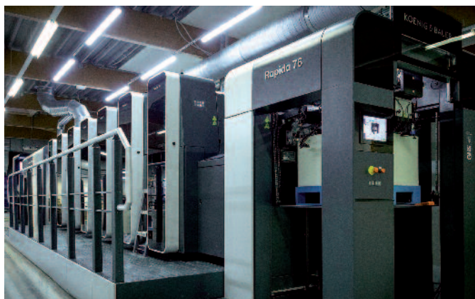
Eine Rapida 76 mit sechs Farbwerken, Lackturm und Auslageverlängerung ging im Frühjahr 2022 bei Edelmann Norderstedt in Betrieb. Über die gelungene Installation freuen
