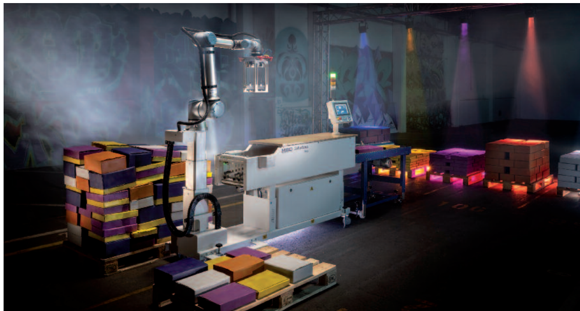
ren werden von der Auslage auf den Tisch des CoBo-Stack befördert. Von dort greift der Cobot die Stapel und setzt sie auf Paletten ab. Dadurch wird der Bediener der Falzmaschine von sämtlicher körperlicher Belastung befreit (Bildquelle: MBO).
