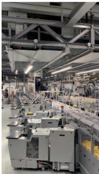
Der Austausch einer MSD-Linie gegen eine EasySert mit FlyStream-Zusammen-tragstrecke ermöglicht es mit kleinster Stückelung flexibel und zuverlässig auf zwei Linien Beilagen-Sets zu produzieren.
