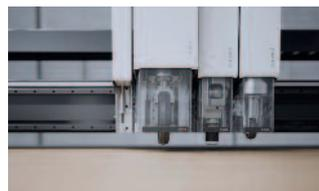
Die neuen Module Automato E und Automato L nehmen die Werkzeuge der neuen Generation auf. Das Automato E zeigt seine Stärke besonders in der Geschwindigkeit, mit der es die eingesetzten Werkzeuge senkt und hebt. Das Automato L ist das Kraftpaket. Es ist etwas größer und kann eine Anpresskraft von beeindruckenden 500 N entwickeln.
