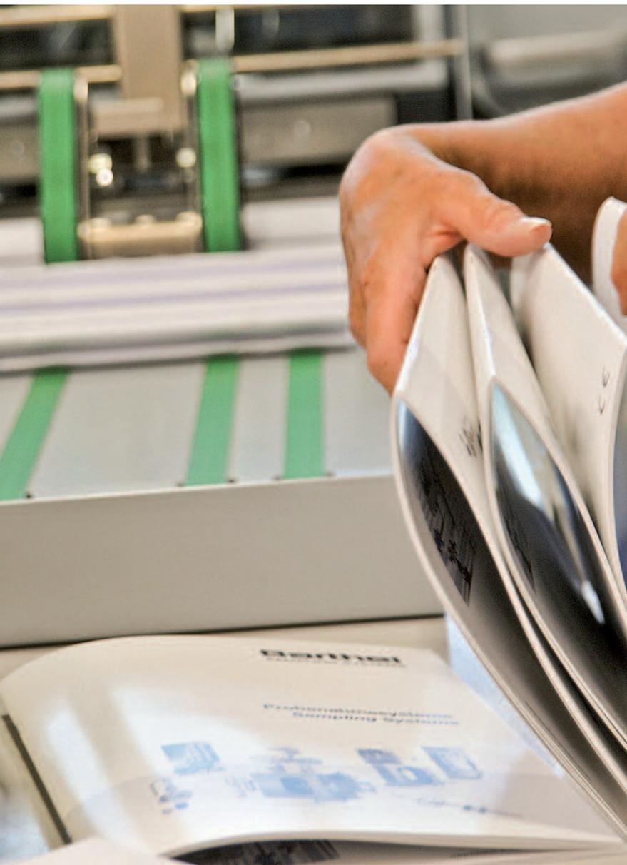
Auslage bei einem StitchLiner Mark III bei der Mediadruckwerk Gruppe. Der Broschürenfertiger kann auf bis zu 60 Stationen ausgebaut werden und erreicht eine Produktionsgeschwindigkeit von bis zu 6.000 Broschüren pro Stunde. Der maximale Umfang je Broschüre beträgt 192 Seiten. (Foto: Horizon)
